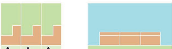
Abb. 19 - Bei gleicher nutzbarer Gartenfläche, gleicher Wohnfläche und gleicher bebauter Grundfläche ist das benötigte Grundstück (Bauland) bei einem Einfamilienhaus am größten. Das Reihenhäuser ist am flächeneffizientesten und der lange Garten lässt sich gut zonieren.
